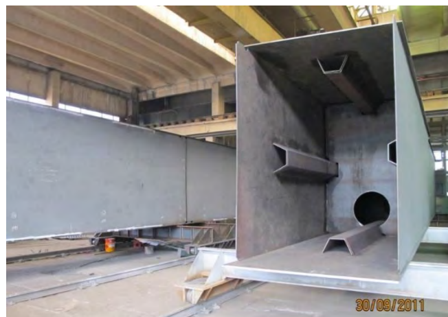
Figura 84. Detalii privitoare la grinzile principale ale podurilor
