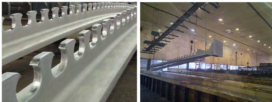
Figura 127. Armătură rigidă din oțel zincată termic
