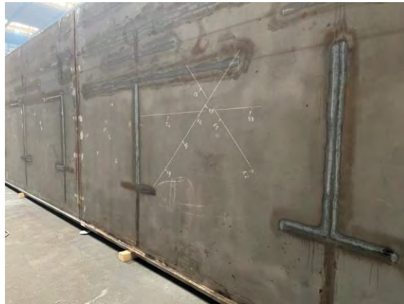
Figura 82. Zonile în care a fost încălzită inima
