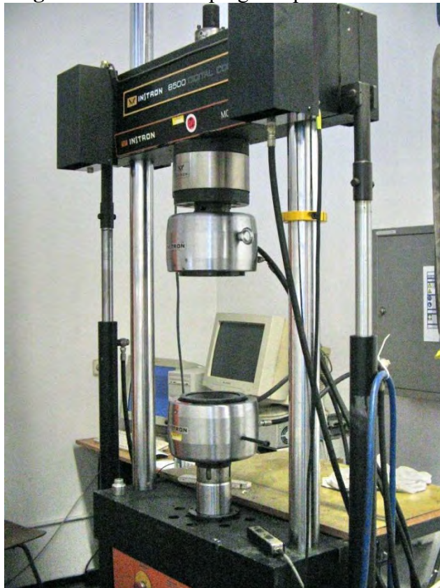
Figura 23. Probă CT pregătită pentru încercare
