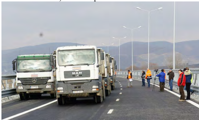
Figura 161. Testul de încărcare cu convoaie de probă a structurii
